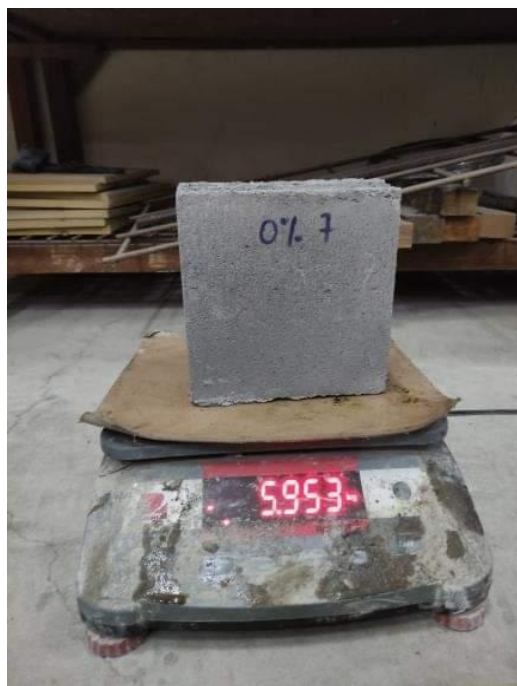
Gambar L-3.6 Penimbangan Benda Uji Kering
