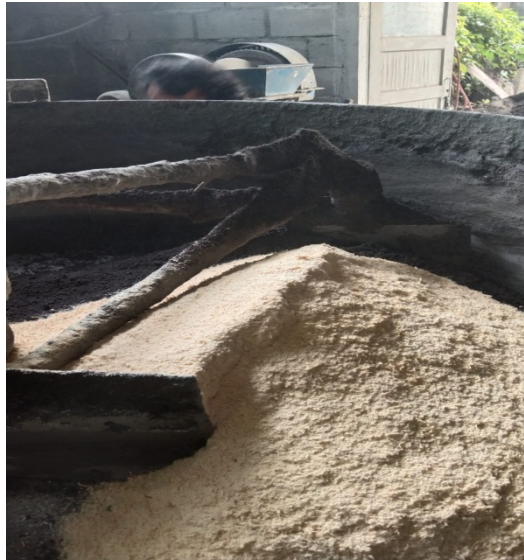
Gambar 4.5 Pencampuran Bahan Susun Batako
