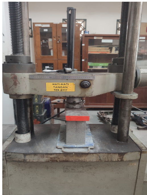
Gambar L-2.1 Pengujian Kuat Tekan
