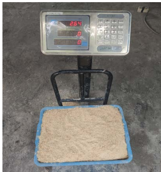
Gambar 4.4 Menimbang Komposisi Bahan Campuran
