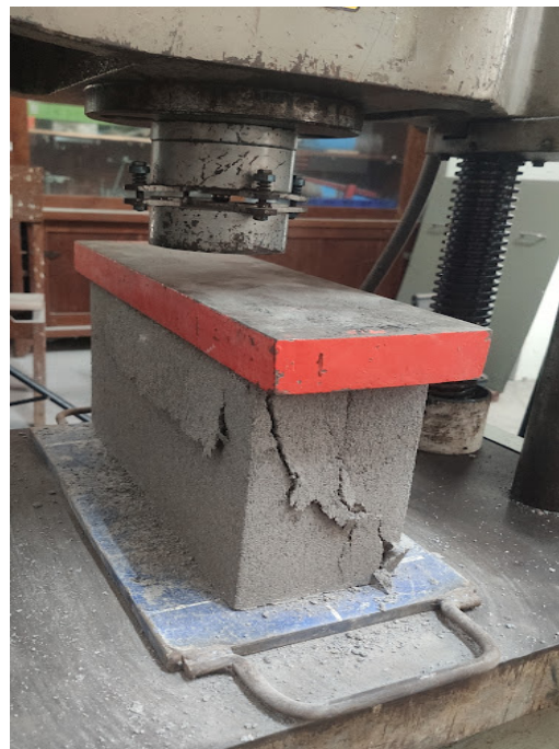
Gambar L-2.2 Benda Uji Setelah Uji Kuat Tekan
