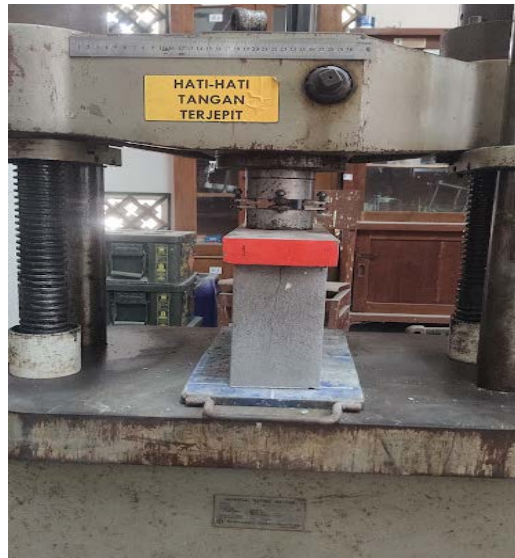
Gambar 4.10 Pengujian Kuat Desak Batako
