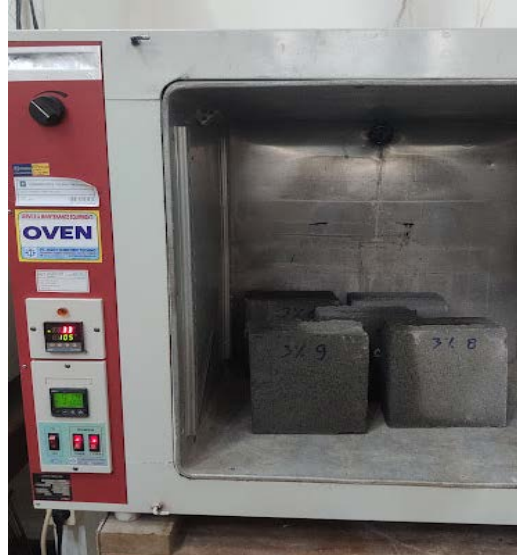
Gambar 4.14 Pengeringan Benda Uji Batako
