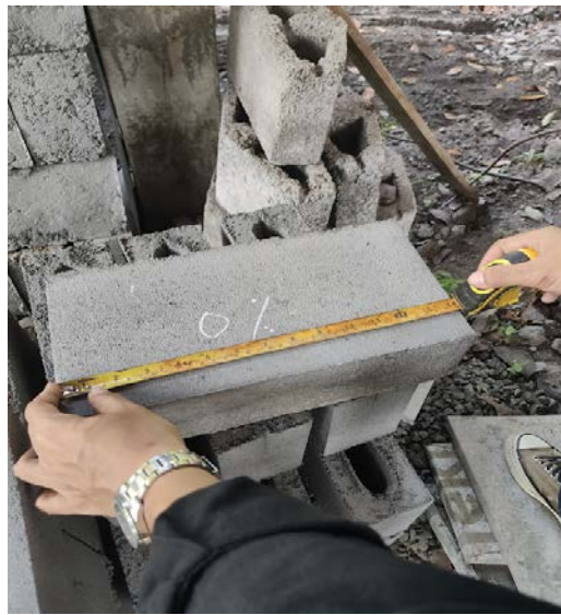
Gambar 4.8 Pengukuran Dimensi Batako
