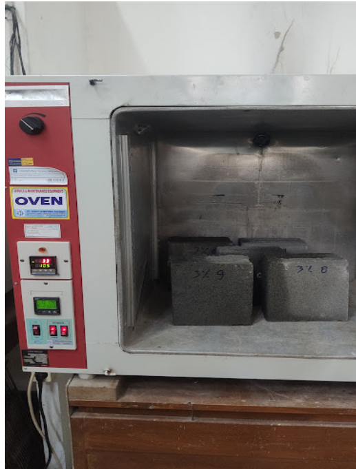
Gambar L-3.5 Pengovenan Benda Uji
