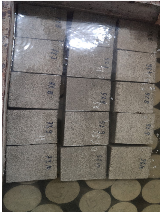
Gambar L-3.3 Perendaman Benda Uji
