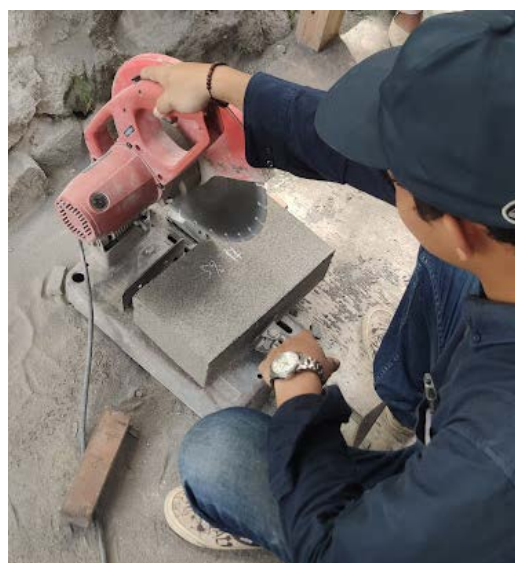
Gambar 4.11 Pemotongan Benda Uji Batako
