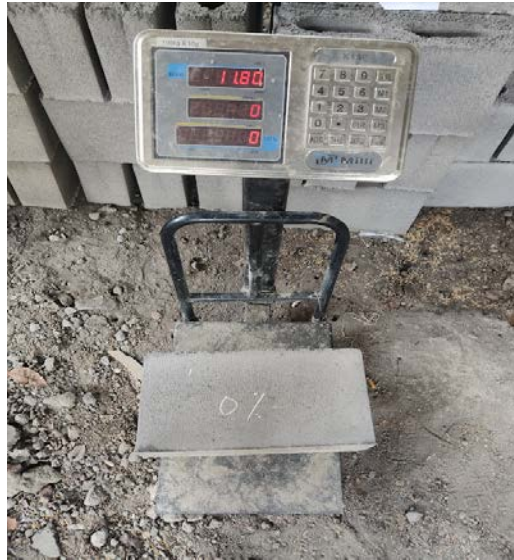
Gambar 4.9 Pengukuran Berat Batako
