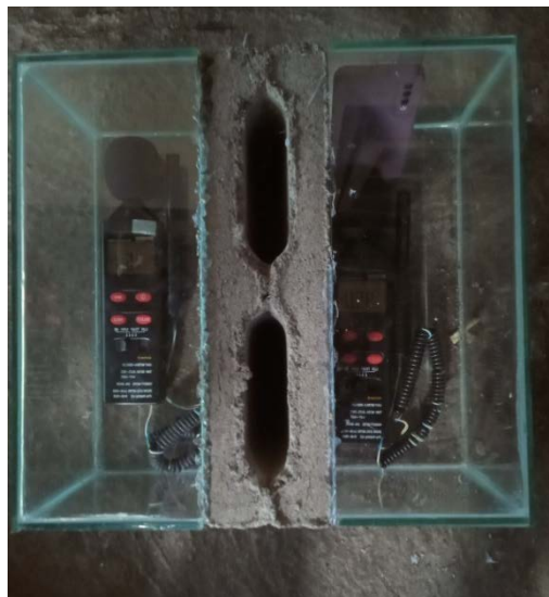
Gambar 4.16 Pengujian Daya Redam Suara
