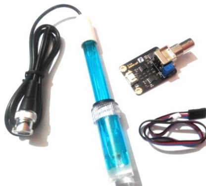
Gambar 3.9 Sensor keasaman dan amplifier
