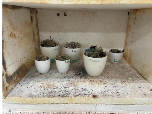
Gambar 4. 12 Proses Pengabuan Sampel Menggunakan Furnace
