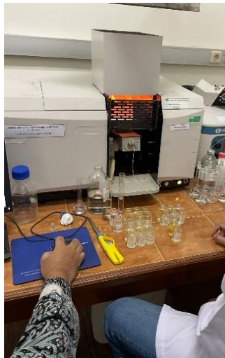
Gambar 4. 14 Pengujian Logam Berat Menggunakan AAS
