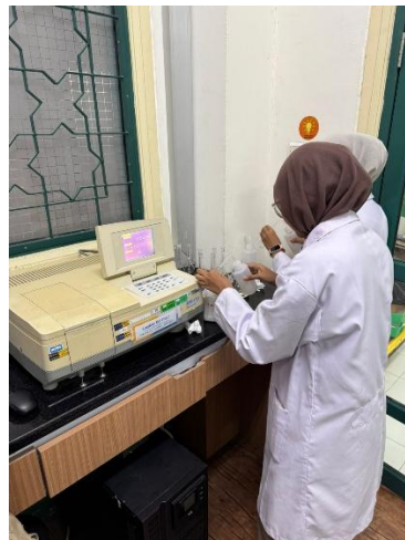
Gambar 4. 15 Pengujian Klorin Menggunakan spektrofotometri UV-Vis.
