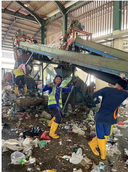
Gambar 4. 6 Alat Pemisahan Sampah dengan Mesin Gibrig
