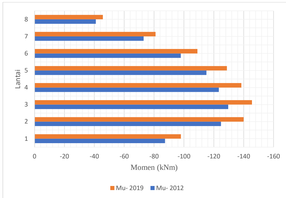
Gambar 5. 30 Grafik Perbandingan Mu- Daerah Lapangan Balok B3 SNI 2012 dan SNI 2019
