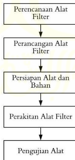
Gambar 3. 3 Diagram Alir Pembuatan Reaktor Eco Filter
