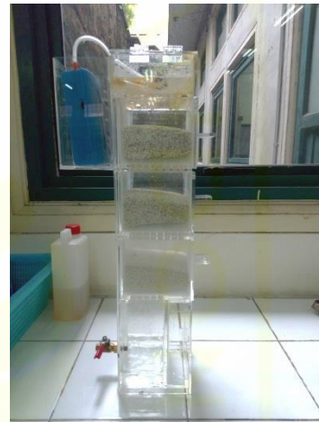
Proses Aerasi - Filtrasi
