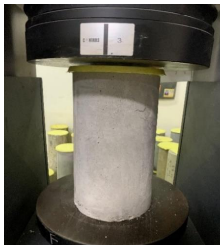
Gambar 5. 10 Pengujian Kuat Desak Beton
