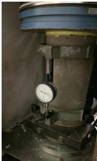
Gambar Lampiran 5.8 Pengujian Kuat Tekan dan Alat Kompresometer
