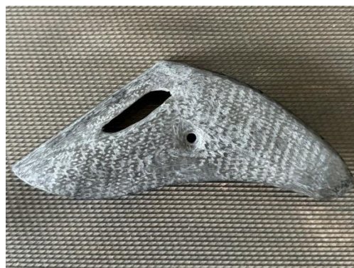
Gambar 4. 3 Sampel 6 (140 °C dengan 10 Lapis)
