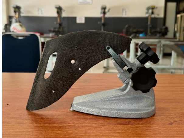
Gambar 3. 30 Pengukuran Ketebalan Point A
