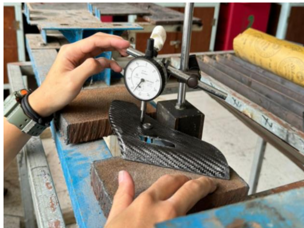
Gambar 3. 36 Pengujian Defleksi Pada Produk
