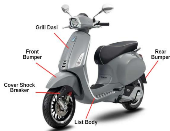
Gambar 2. 1 Komponen Body Vespa Sprint 150
