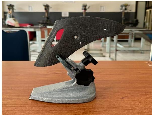
Gambar 3. 32 Pengukuran Ketebalan Point C
