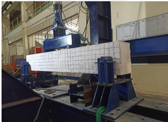
Gambar 5. 5 Pemodelan Pembebanan Benda Uji Eksperimental
