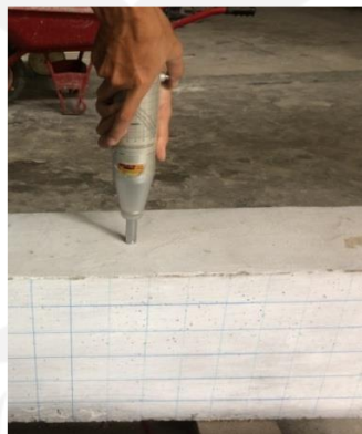
Gambar 5. 1 Pengujian Hammer Test pada Balok Benda Uji
