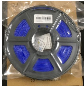
Gambar 3.2 Filament TPU (Lab 3D print Teknik Mesin Universitas Islam Indonesia)
