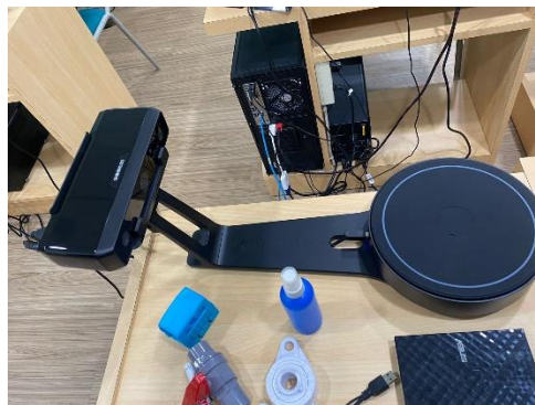
Gambar 3.1 3D Scan EnsScan (Lab CAD CAE Teknik Mesin Universitas Islam Indonesia)
