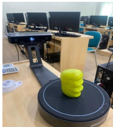
Gambar 3.7 Proses 3D Scan (Lab. CAD CAE Teknik Mesin Universitas Islam Indonesia)
