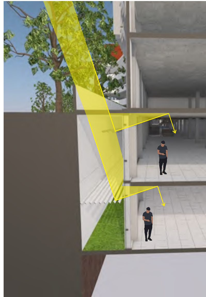
MASUKNYA DAYLIGHTING KE BASEMENT BANGUNAN
