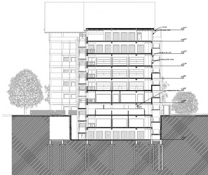
Gambar 7. 1 Potongan Sebelum Perbaikan
