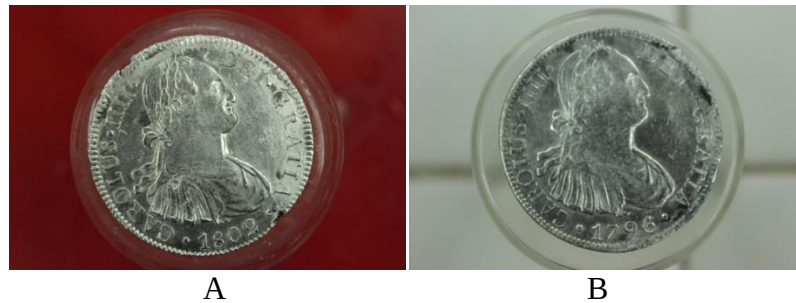
Gambar 24. Koin kelompok A setelah penempelan pasta tampak mengkilap sedangkan koin kelompok B setelah penempelan pasta masih tampak kusam.
