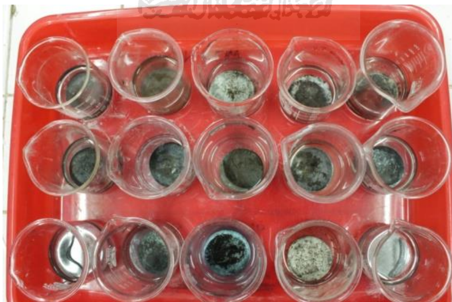
Gambar 20. Proses perendaman koin perak dengan larutan natrium karbonat 5%
