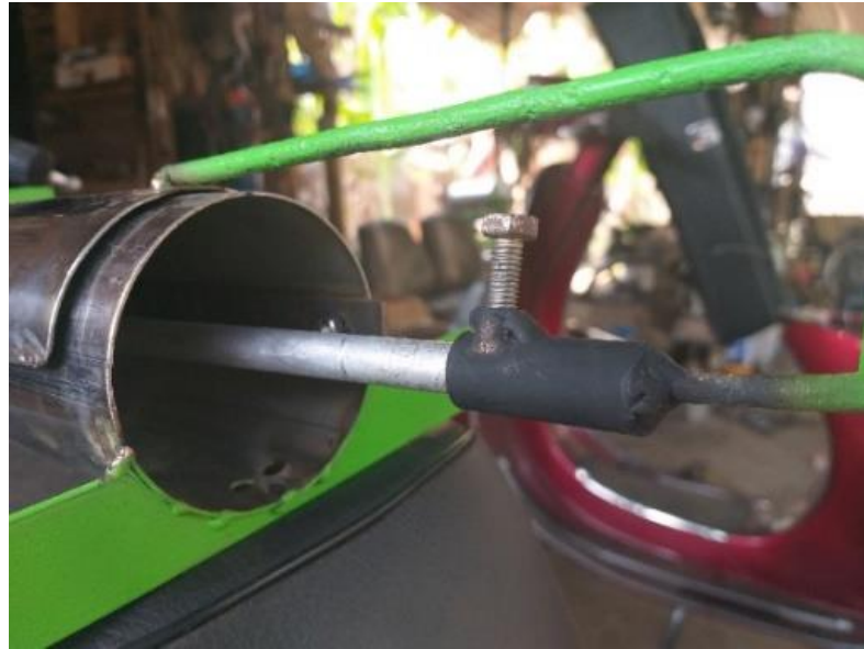
Gambar 4-20 Penambahan Pendorong Pada Pipa penyayat
