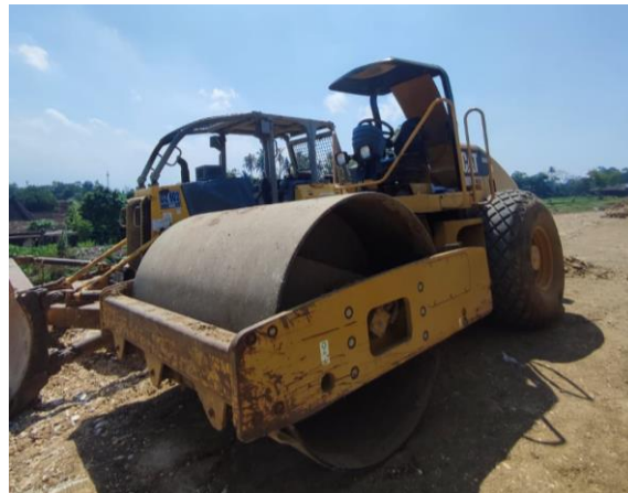
Gambar 5. 16 Vibrator Roller Cat Cs533e (Sumber: Dokumetasi pribadi, 2024)
