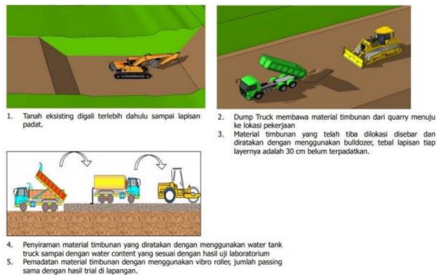
Gambar 5.2 Ilustrasi pekerjaan Timbunan (Sumber: PT Adhi Karya (Persero) Tbk, 2022)
