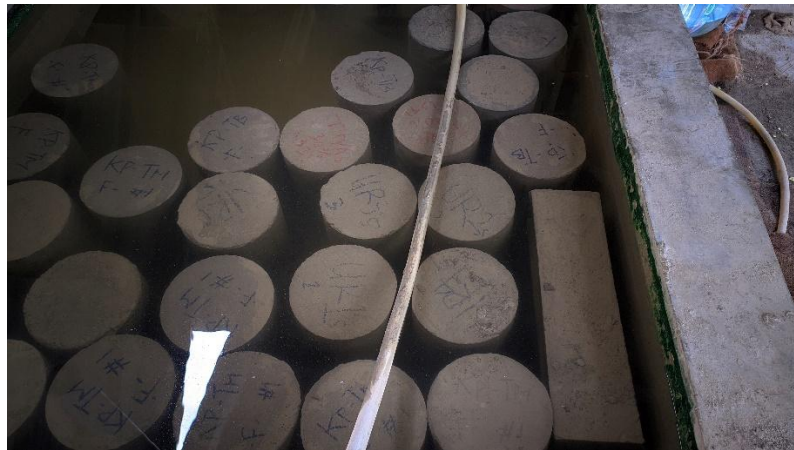
Gambar 4.1 Perendaman benda uji beton
