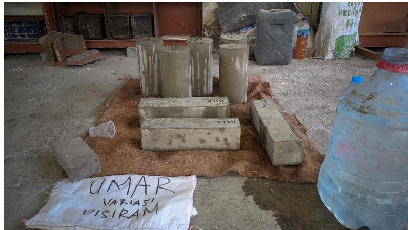
Gambar 4.2 Penyiraman benda uji beton
