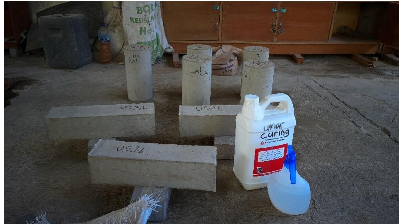
Gambar 4.3 Penyemprotan curing compound
