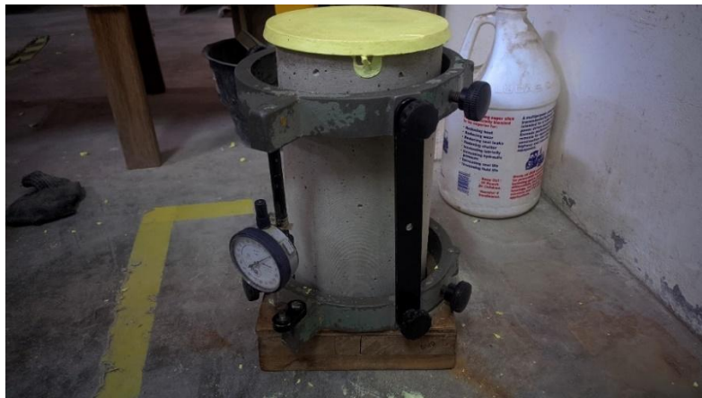
Gambar 5.10 Pemasangan alat uji deformasi modulus elastisitas pada sampel
