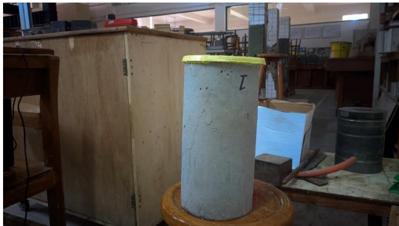
Gambar 5.16 Kerusakan benda uji silinder setelah pengujian
