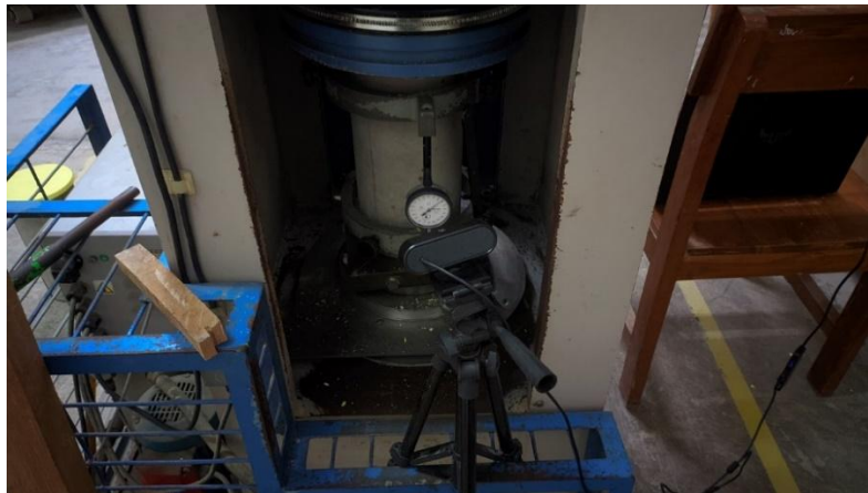
Gambar 5.8 Pengujian kuat tekan dan modulus elastisitas beton
