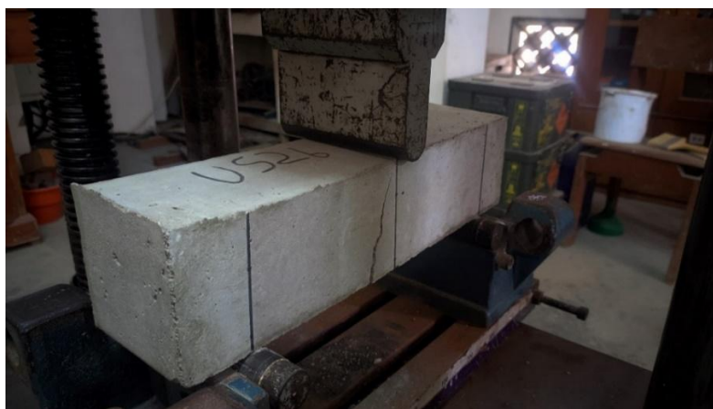
Gambar 5.19 Kerusakan benda uji balok setelah pengujian
