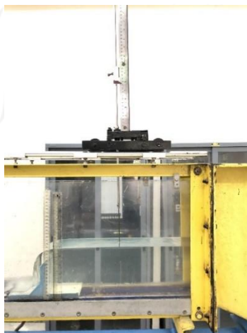
Gambar 5.1 Pengukuran Tinggi Peluapan Pada Peluap Segiempat
