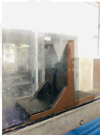
Gambar 4.8 Pemasangan Peluap V-Notch Pada Flume
