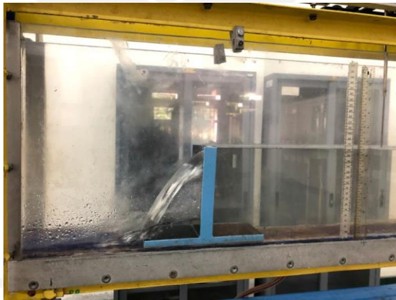
Gambar 4.9 Eksperimen Aliran Dengan Tinggi Peluapan Pada Peluap Cipoletti
