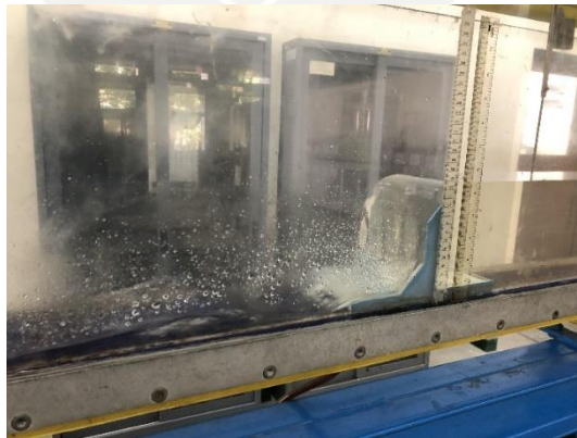
Gambar 4.7 Eksperimen Aliran Dengan Tinggi Peluapan Pada Peluap Segiempat
