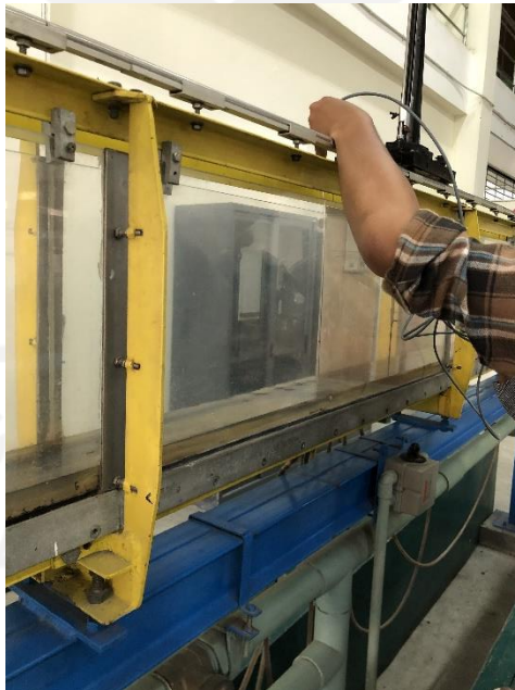
Gambar L-1.4 Pengukuran Menggunakan Current Meter
