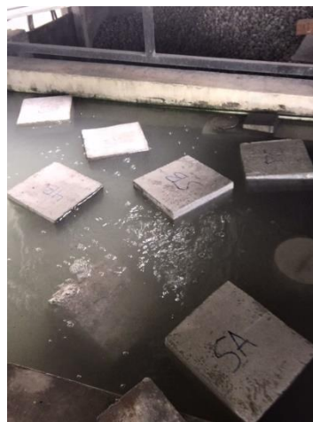
Gambar 4. 21 Pengujian Bobot Isi dan Penyerapan Air
