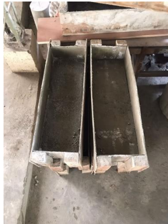
Gambar 4.2 Cetakan Bata Ringan
