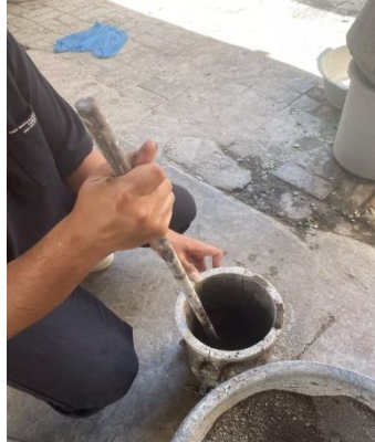
Gambar 4.12 Pengujian Berat Volue Padat Agregat Halus
