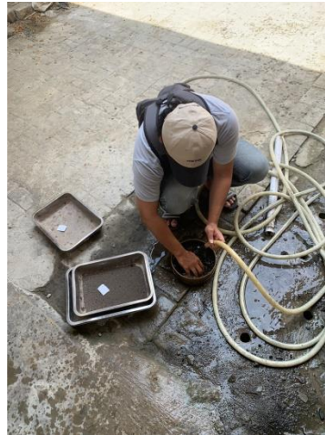
Gambar 4.16 Pengujian Kandungan Lumpur
