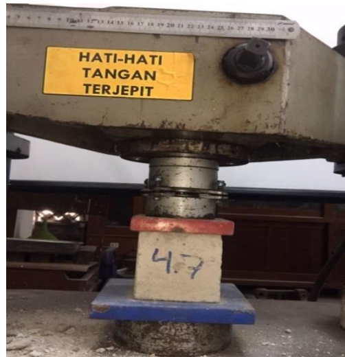
Gambar 5.6 Setting Up Bata Ringan Untuk Uji Kuat Tekan
