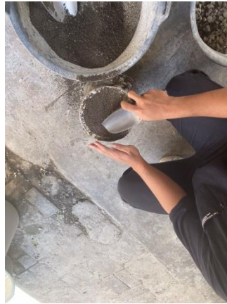
Gambar 4.13 Pengujian Berat Volume Gembur Agregat Halus
