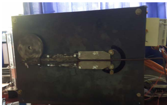
Gambar 4-14 Besi tulangan yang berputar kebawah karena cengkaman tidak erat
