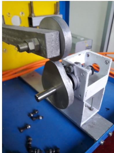
Gambar 3-22 Linkage antara motor dengan pemotong
