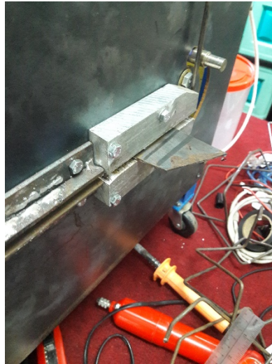
Gambar 4-16 Penyisipan besi pada pencekam akhir
