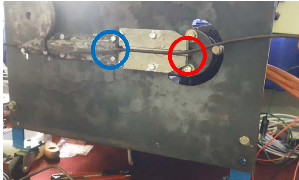
Gambar 4-15 Lingkaran merah merupakan titik momen, lingkaran biru daerah perpindahan momen
