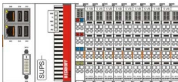
Gambar 2-3 Ilustrasi PLC Beckhoff
