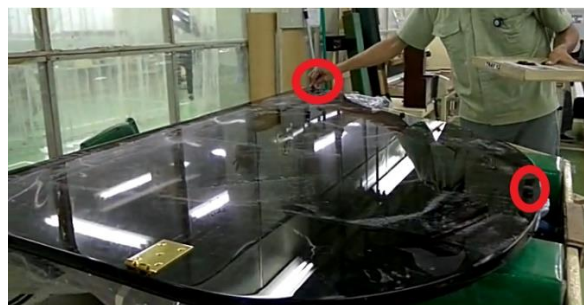
Gambar 3-13 Pemasangan Rubber dan Lid Prop Cup
