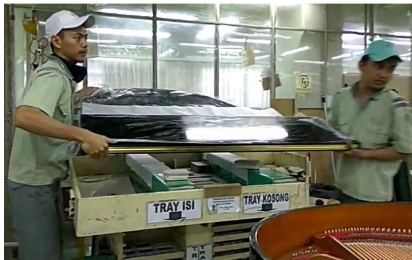
Gambar 3-14 Pengangkatan Top Board dari Meja Kerja ke Piano
