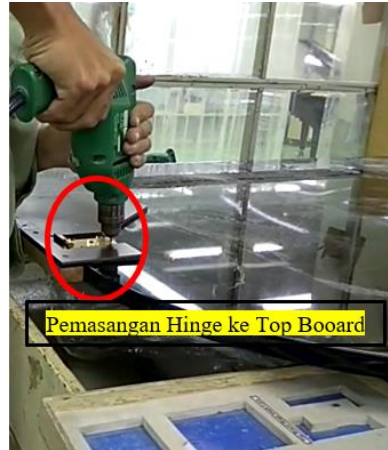
Gambar 3-12 Pemasangan Hinge pada Top Board Rear
