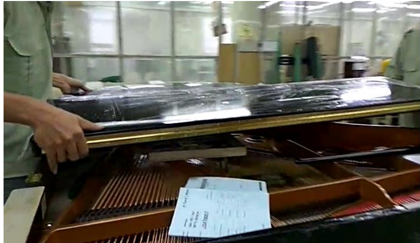
Gambar 3-10 Pengangkatan Top Board ke Piano Untuk Pengukuran Hinge Top Board
