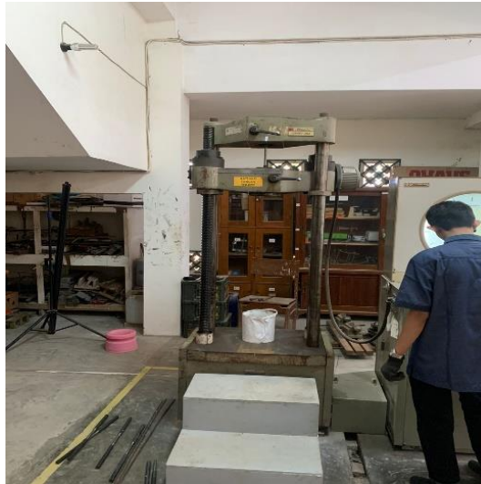
Gambar 4. 7 Mesin Uji Kuat Tekan
