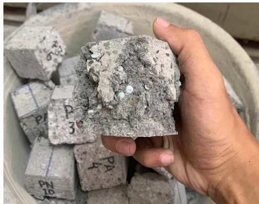
Gambar L-3. 4 Benda Uji Setelah Uji Kuat Tekan
