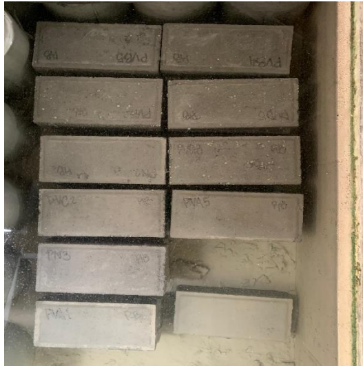
Gambar 5. 9 Pengujian Penyerapan Air Paving Block
