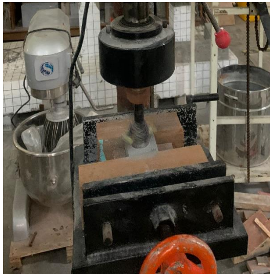
Gambar 5. 7 Pengujian Ketahanan Aus Paving Block
