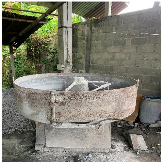
Gambar 4. 2 Mesin Pengaduk ( Mixer )
