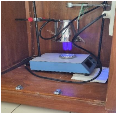
Plastik PP di fotodegradasi selama 7 hari dengan UV 20 watt
